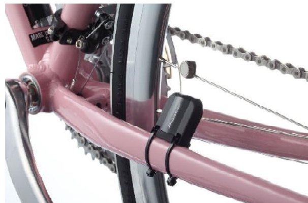
同梱のケイデンスセンサー。無線で『ポタナビ』と連携し、理想的な走りを手助けします。
